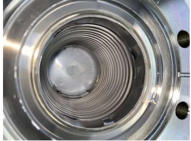
無酸素 Pd/Ti コーティング後の ICF114 成形ベローズ
