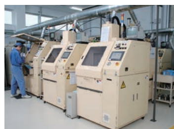
溶接ペローズ用レーザー溶接
