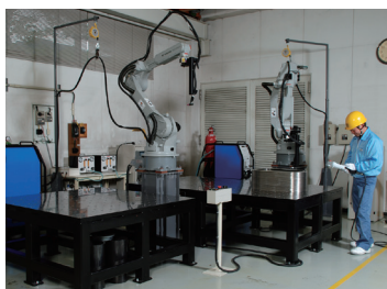
溶接ロボット
