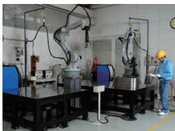
溶接ロボット
