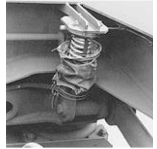
コンテナ車に組み込まれた測量弁
